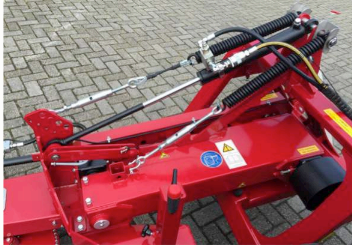
Parallellogram constructie met ontlastveren
