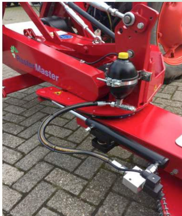
Hydraulische armcilinder met accumulator
