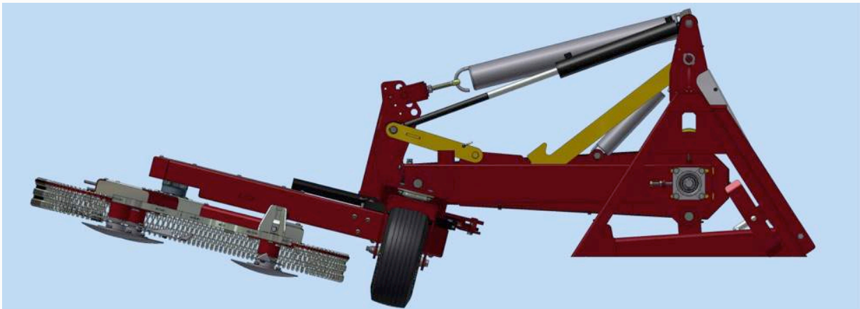
3D Beispiel der Anhebung um 5° (achten Sie darauf, dass kein Stützrad verwendet wird!)
