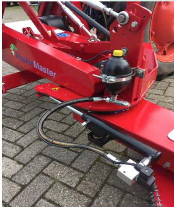
Hydraulischer Armzylinder mit Akkumulator
