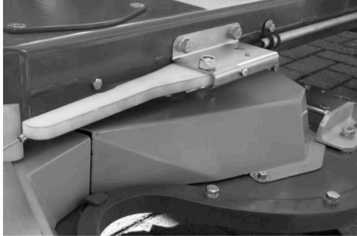
Exemple d'un capteur sur le bras de fauchage
