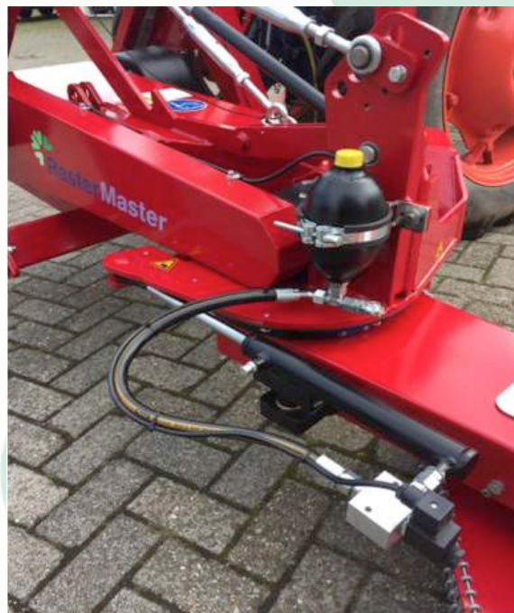
Cylindre de bras hydraulique avec accumulateur
