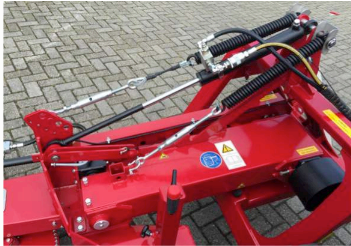
Construction en parallélogramme avec vérins d'allègement
