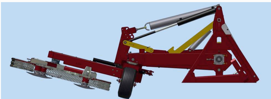
Exemple en 3D d'un soulèvement de 5° (notez que la roue d'appui n'est pas utilisée !)
