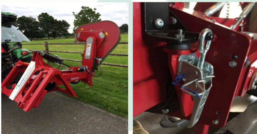
Position de transport et verrouillage du bras de fauchage
